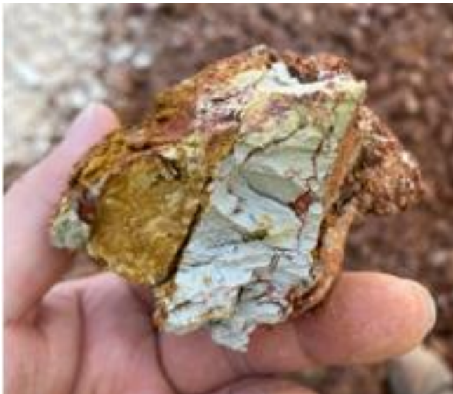
Figura 6. Limolita brechada con clastos de limolita con alteración argílica 2 y óxidos de jarosita-hematita en fractura. (M7A)
