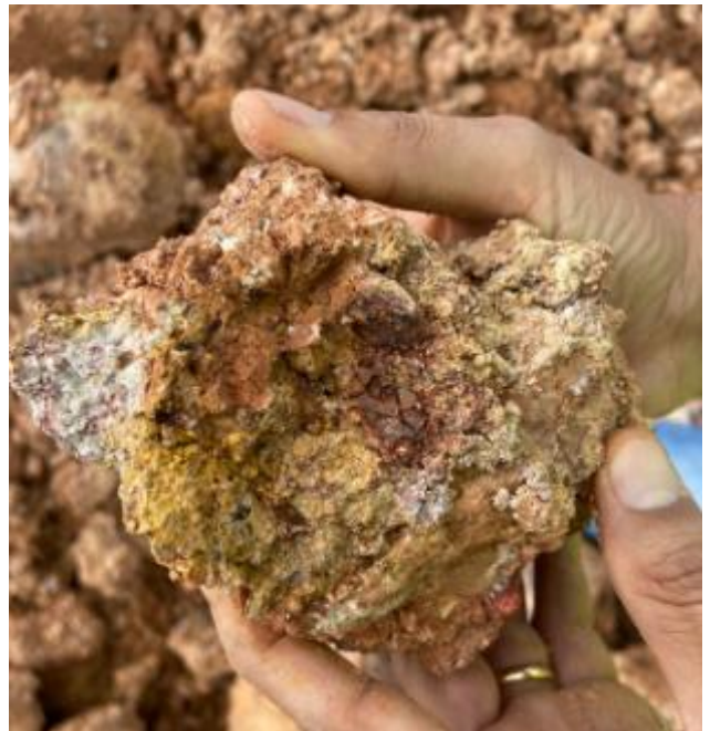
Figura 8. Brecha lixiviada con alteración argílica 2, presencia de clastos de limolita con alteración silíceá 1. Hematitas en fracturas y matriz, así como jarositas en matriz de brecha. (M5)
